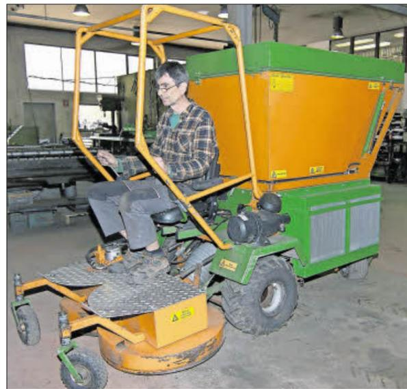
Schneidet Grün auf 1,25 Meter Breite und saugt den Sammelbehälter in nur einer Viertelstunde voll: Der von kommunalen Grünflächenbetrieben genutzte Absaugmäher ASM 125 ist eine typische Werner-Maschine. Stahlbauschlosser Reiner Fischer baut ihn in Mittelbach von Grund auf mit. FOTO: STEINMETZ
